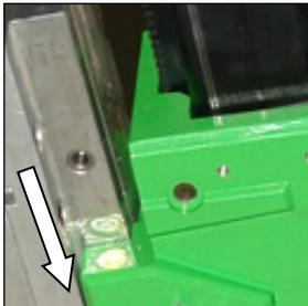
Setzen Sie die Kernbohrmaschine mit der montierten Platte in den Bohrständer ein und Arretieren Sie diese mit Hilfe der Feststellschrauben.
