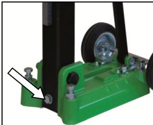
Entfernen Sie die Schraube welche die Bohrsäule bei 90° arretiert.
