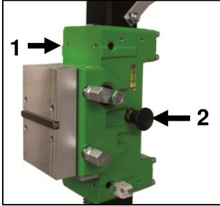
Um den Schlitten (1) zu entriegeln, ziehen Sie den Sicherungsknopf (2) heraus.
