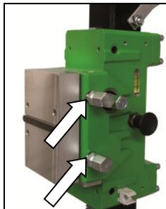
Déplacez le support de la machine vers le haut jusqu'à ce qu'il se verrouille en position haute.
