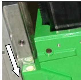
Insérez la caroteuse avec le support de montage joint dans le support de forage et bloquez-le avec la manette (voir photo ci-dessus).
