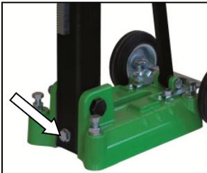
Verwijder de schroef die de pilaar op 90° vergrendele.
