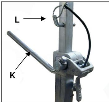
Fixieren Sie den Bohrständer durch Drehen der Kurbel (K) im Uhrzeigersinn. Sichern Sie die Einstellung mit dem dazugehörigen Bolzen (L).
