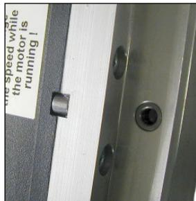
L'outil est fourni avec un support de montage, une clé de 10mm et 4 vis Allen M8x20. Le support de montage est placé sur la caroteuse avec la clé et fixé au moyen des 4 vis.
