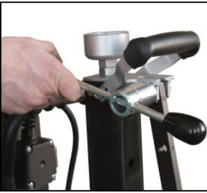
Öffnen Sie mit dem Drehkreuz die obere Schraube der Abstützung und entfernen Sie diese.
