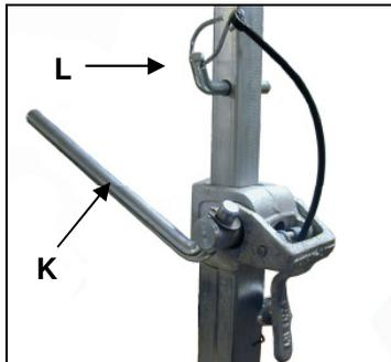
Fixez le support en tournant la manivelle (K) dans le sens des aiguilles d'une montre.
