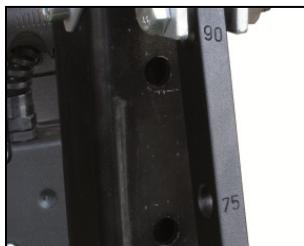
Les angles d'inclinaison que peuvent être réglées de différentes manières sont marqués dans l'appui arrière.
