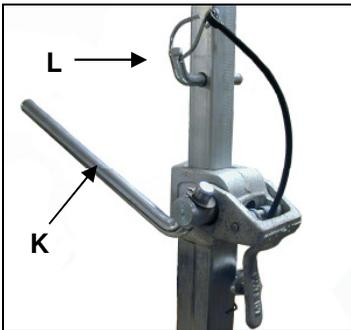
Bevestig de boorinstallatie door de arm (K) rechtsom te draaien. Zet het vast in positie d.m.v. de daarvoor bestemde bout (L).
